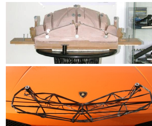
XFK in 3D - Stoßfänger-Innenstruktur Eine Marke der AMC
