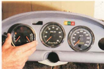
Zusammenbau des Armaturenbretts. Das Loch in der Mitte ist für die Lenksäule
