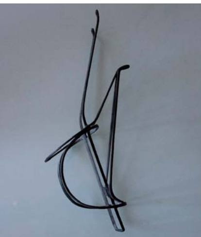
Beispiel für „form follows force“: Ultraleichter Flaschenhalter aus einer 3D-gewickelten CFK-Endlosfaser nach dem Prinzip „xFK in 3D“ – hier für den Motorsport. Bild: AMC / Lasso
