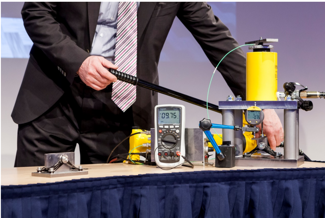
Mit fast 10 KN wurde die Konsole belastet.
