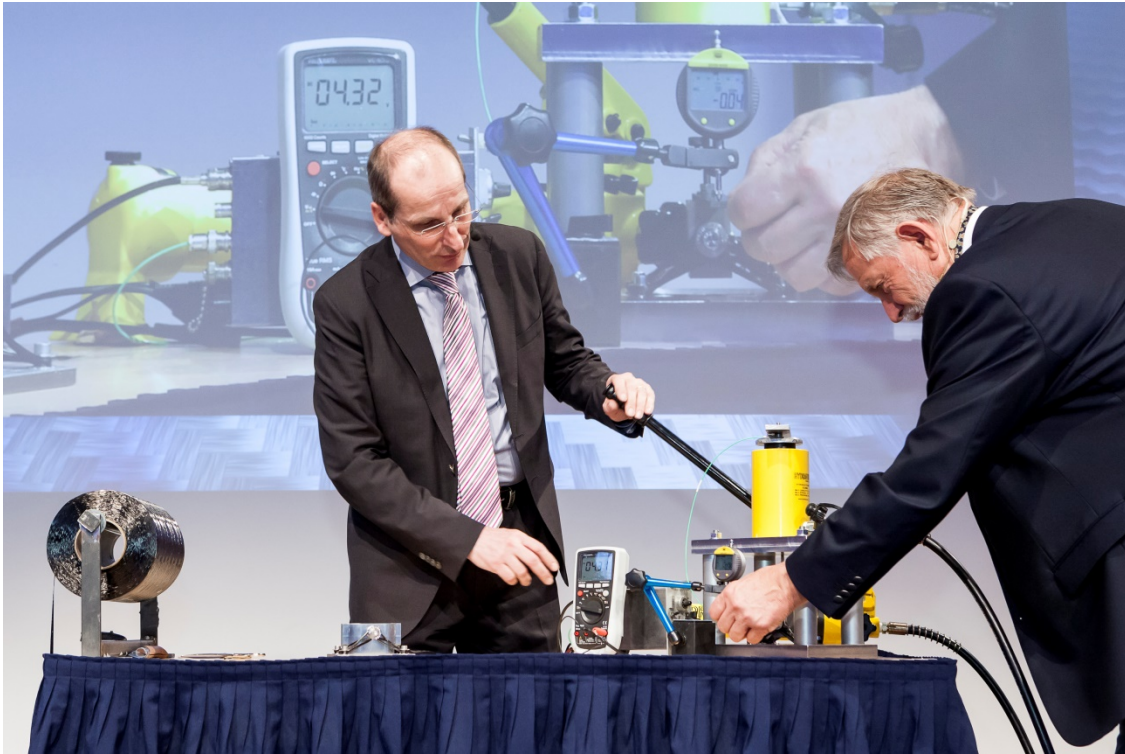
Auf dem Prüfstand: Die xFK in 3D-Konsole wird von Peter Fassbaender und Dr. Ulrich Hindenlang einem Belastungstest unterzogen. Bei 1 Tonne beendeten die Experten ihre Vorführung, da zerstörungsfrei geprüft werden sollte.
